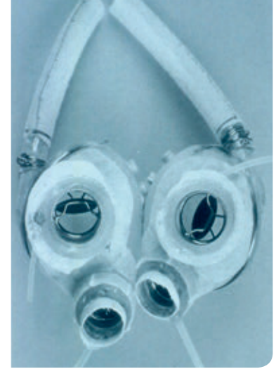
Abb. 2: Prototyp des ersten Kunstherzens von Dr. Akutsu und Dr. Kolff aus dem Jahr 1957.
