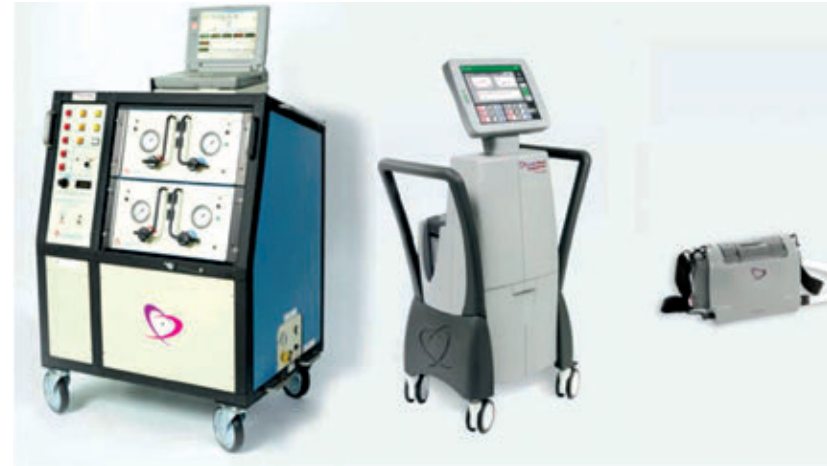
Abb. 28: Technische Evolution der Antriebseinheiten des SynCardia-TAH: Die Abbildung erlaubt einen Größenvergleich zwischen den im Bild von links nach rechts dargestellten Konsolen „Big Blue“, Companion-Driver und Freedom-Driver.
